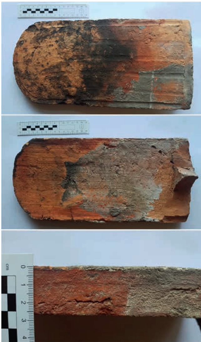
7. Miłaków, kościół parafialny pw. św. Bartłomieja Apostoła, najstarszy typ dachówki karpiówki (fot. A. Duda)
