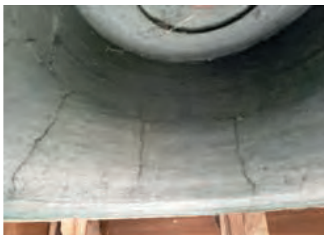
Ryc. 6. Wewnętrzna powierzchnia tuby i widoczne wady odlewnicze, fot. M. Tureczek
