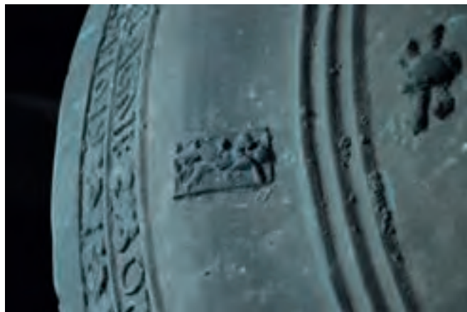
3. Tlenki i zapiaszczenia w obrębie dekoracji, fot. M. Poźniak, M. Tureczek
