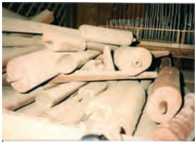
Ryc. 17. Jelenia Góra – Cieplice Śląskie-Zdrój, kościół pw. Świętego Jana Chrzciciela. Piszczalki głosu Trompete 8' według patentu Stillera, fot. Zakład Organmistrzowski Antoniego Szydłowskiego, 2000
