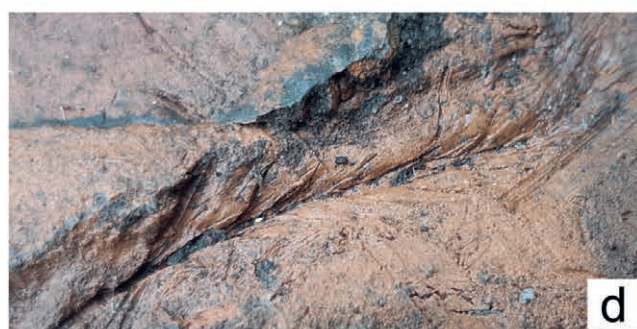
Ryc. 10. Przykłady odcisków roślin na ceglach: a) odcisk długiej igły na cegle w elewacji kościoła parafialnego pw. Chrystusa Króla w Dobięgniewie, b) odciski igliwia na cegle w gruzie przy kościele ewangelickim w Radoszynie, gm. Skąpe, c) odciski igliwia i fragmentów traw na cegle budynku mieszkalnego w Bojadłach, gm. Bojadła, d) odcisk kłosa na cegle z Zatonia, fot. A. Duda 2020 r.
