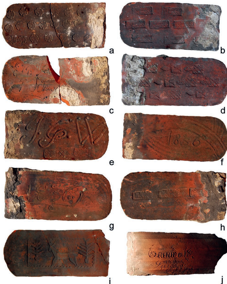
Ryc. 8. Przykłady inskrypcji i oznaczeń na dachówkach karpiówkach: a) oznaczenia stemplem z motywem gwiazdki, dachówka z kościoła parafialnego pw. św. Marcina w Świdnicy, b) oznaczenie prostokątnym stemplem z motywem przekreślonego kwadratu i uproszczoną formą drzewka, dachówka z kościoła parafialnego pw. św. Marcina w Świdnicy, c) inskrypcja oraz data na dachówce z kościoła parafialnego pw. św. Marcina w Świdnicy, d) dwa rodzaje stempli z motywem kwadratu zawierającego kratkę i gwiazdkę oraz zwieńczenie w formie płomienia, dachówka z kościoła parafialnego pw. św. Marcina w Świdnicy, e) inskrypcja o treści: J-S-W oraz prostokątne stemple, dachówka z kościoła parafialnego pw. św. Marcina w Świdnicy, f) data 1850 ujęta w łukowo ukształtowanie żłobkowanie, dachówka z kościoła parafialnego pw. św. Marcina w Świdnicy, g) data 1836 ze śladami żłobkowania wzdłuż krawędzi, dachówka z kościoła parafialnego pw. św. Marcina w Świdnicy, h) oznaczenie prostokątnym stemplem z motywem roślinnym, dachówka z kościoła parafialnego pw. św. Marcina w Świdnicy, i) duży stempel z dekoracyjnym żąbkowaniem przy krawędziach, zawierający uproszczony wizerunek jelenia oraz dwa flankujące drzewka w niewielkich doniczkach, dachówka z budynku gospodarczego w Wojcieszycach, gm. Kłodawa, j) inskrypcja o treści Grundwald / aüs / Sagan, dachówka z pałacu w Borowinie, gm. Szprotawa, fot. A. Duda 2020 r.
