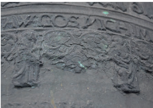
Ryc. 5. Zanieczyszczenia i tlenki miedzi w obrębie dekoracji, fot. M. Tureczek 2020 r.
