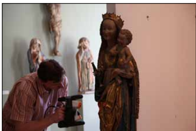
3. Skanowanie oryginalnych figur.
