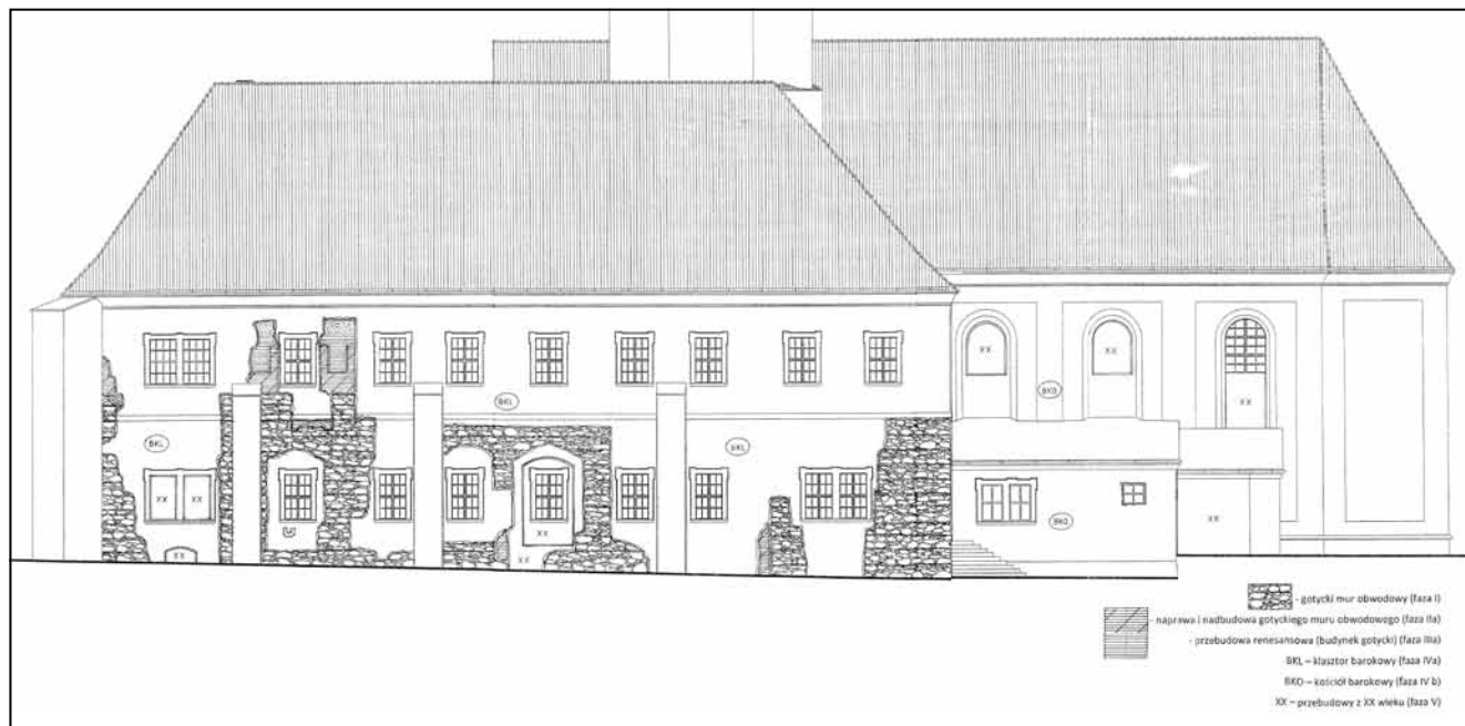
Ryc. 13. Koźuchów, zamek, elewacja północna z oznaczeniem faz średniowiecznych i renesansowych: wątek kamienny – 1. połowa XIV w., wątek ceglany – 1. poł. XV w. (oprac. A. Legendziewicz).
