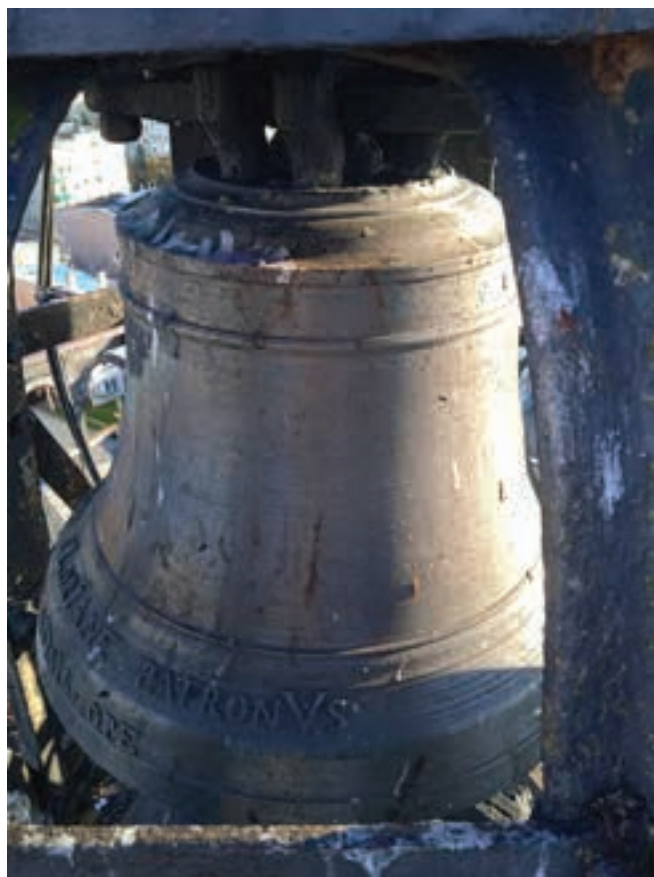
7. Powierzchnia dzwonu z 1732 roku z licznymi ubytkami wżerowymi i niedolewami. Fot. M. Tureczek
