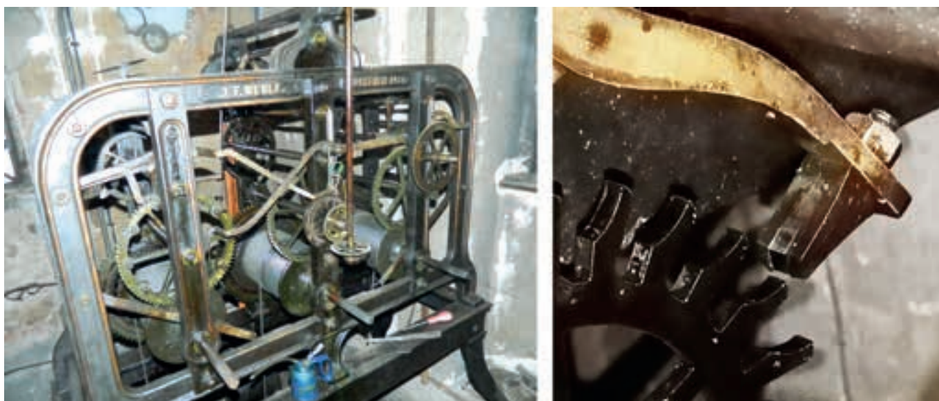
Ryc. 7. Widok ogólny mechanizmu zegara oraz detal wychwyty. Fot. K. Kurek
