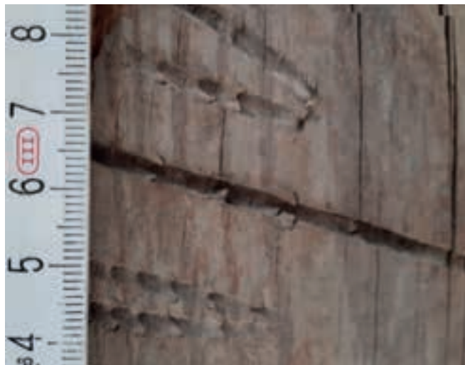
14. Fragment znaku handlowego z wymiarowaniem żłobienia. Na zdjęciu widoczne zadziory włókien drewna wskazujące na kierunek prowadzenia narzędzia żłobiącego. Fot. A. Duda, 2022
