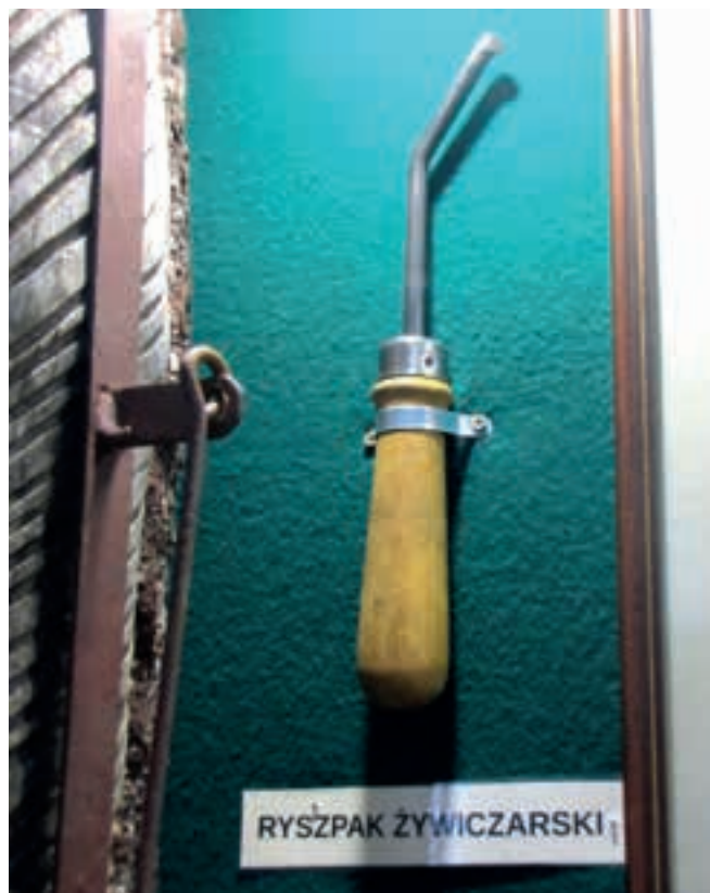
17. Ryszpak żywiczarski wykorzystywany do pozyskiwania żywicy. Ekspонат prezentowany na wystawie w budynku Nadleśnictwa w Świebodzinie. Fot. A. Duda, 2022
