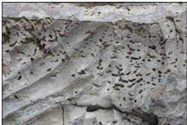
Il. 24. Zdjęcie fragmentu chrzcielnicy ilustrujące stan zachowania drewna zniszczonego działalnością owadów oraz resztki pierwotnego opracowania pozłotniczego.
